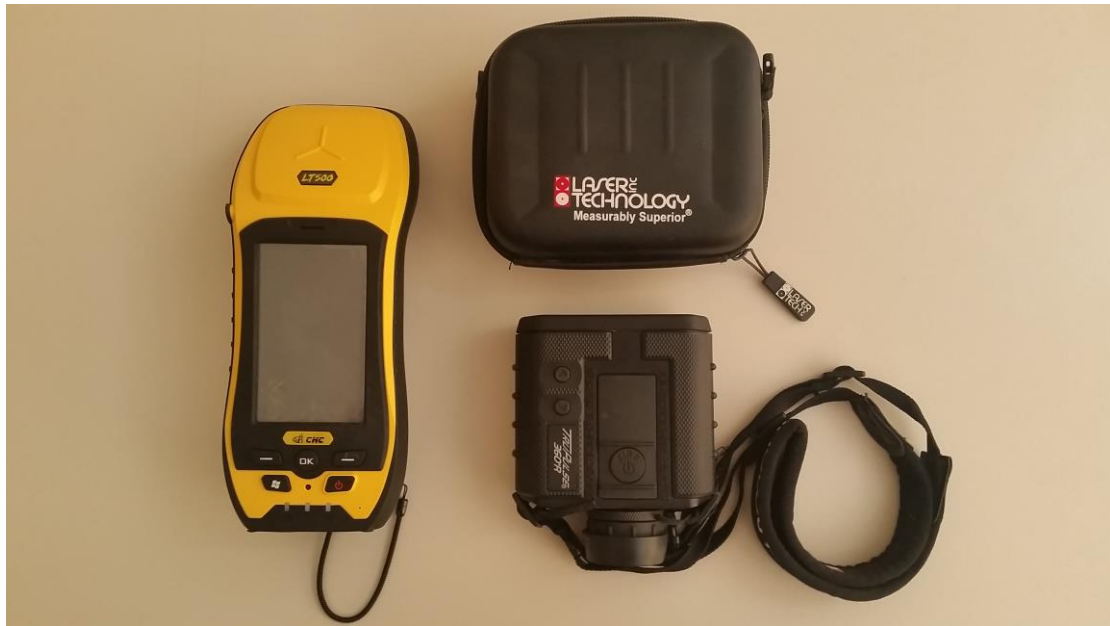
Εικόνα 2. Χαρτογραφικό σύστημα GIS αποτελούμενο από δέκτη GNSS τύπου CHC LT500U (επάνω) και αποστασιόμετρο laser τύπου LTI TruPulse 360R (κάτω).
