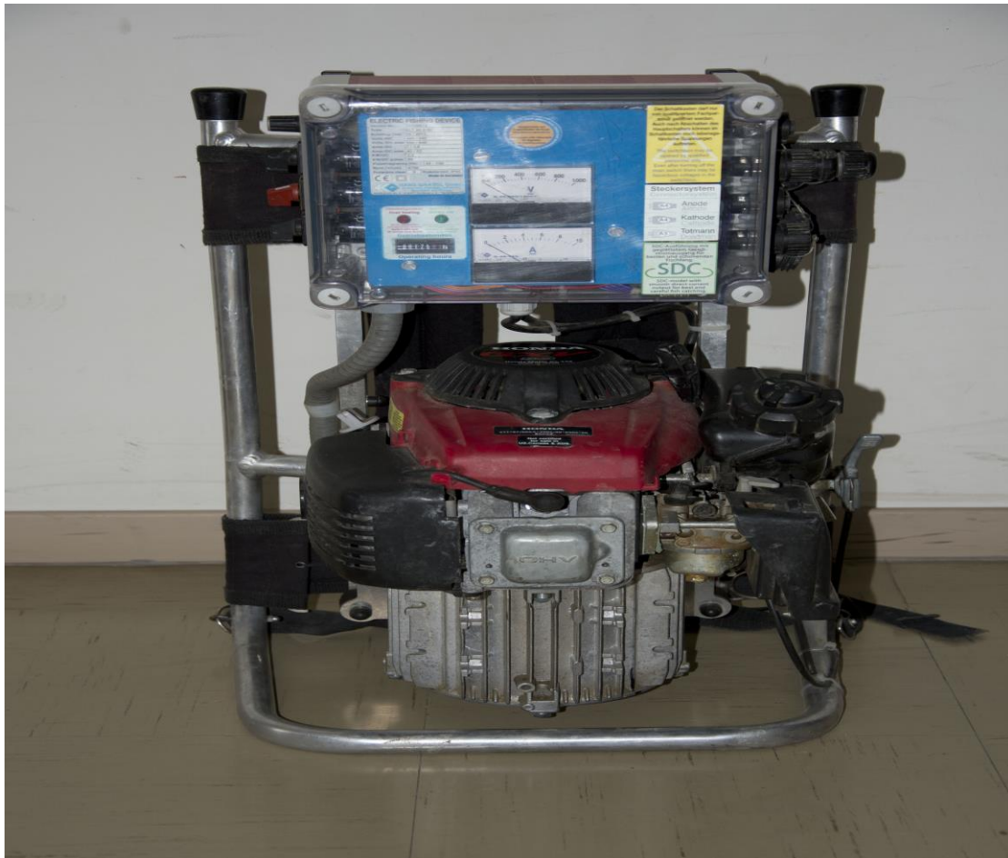
Εικόνα 7. Ηλεκτραλιεία φορητή backpack τύπου Hans Grassl GmbH ELT 60 ισχύος 1,3Kw.
