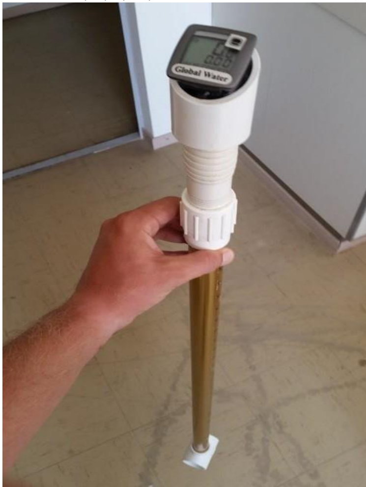
Εικόνα 5. Ροόμετρο με προπέλα τύπου FP101 Flow Probe της Global Water.
