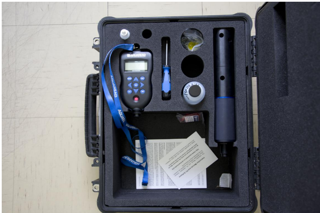
Εικόνα 3. Όργανο μέτρησης ποιότητας νερού Aquameter 200 με πολυαισθητήρας τύπου AP 5000.
