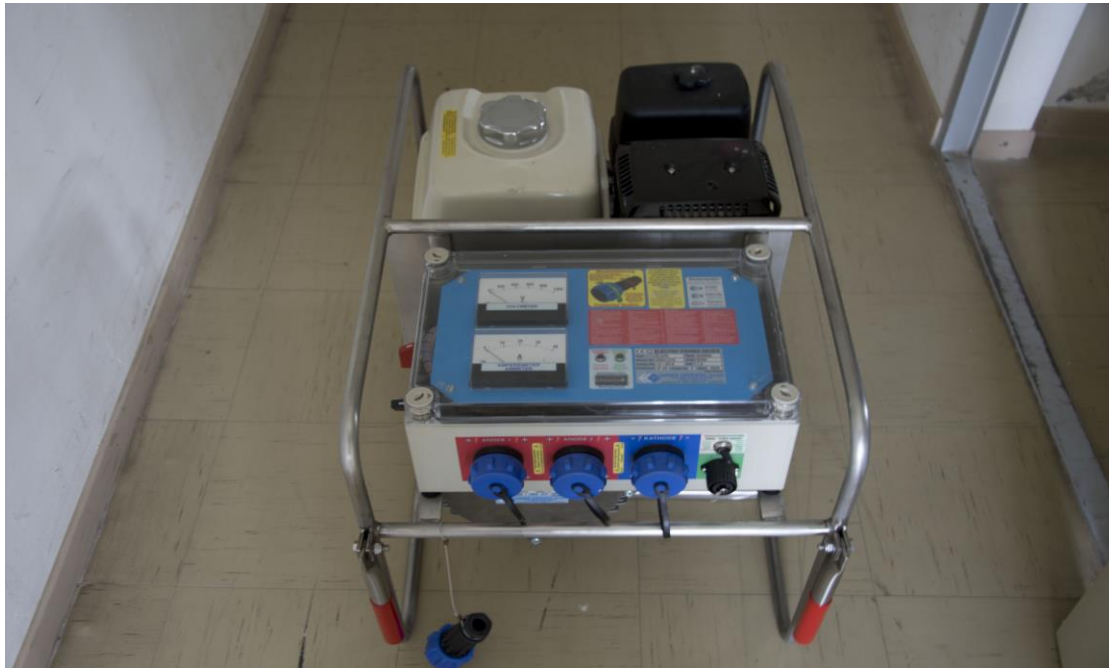
Εικόνα 6. Ηλεκτραλιεία όχθης τύπου Hans Grassl GmbH EL64II ισχύος 7,0Kw.
