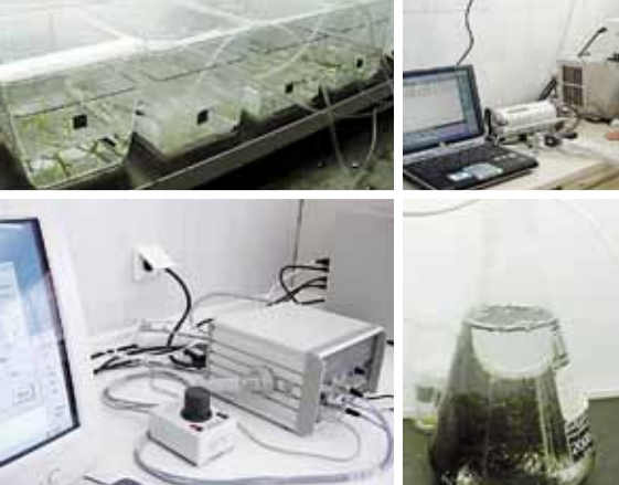
Εικόνα 28. Εγκαταστάσεις και όργανα υψηλής (PAM-Fluorometers) και συμβατικής (Οξυγονόμετρο) τεχνολογίας, για τη μέτρηση της φωτοσύνθεσης των θαλάσσιων φυκών (φυτοπλανκτό, μακροφύκη) και αγγειόσπερμων.
